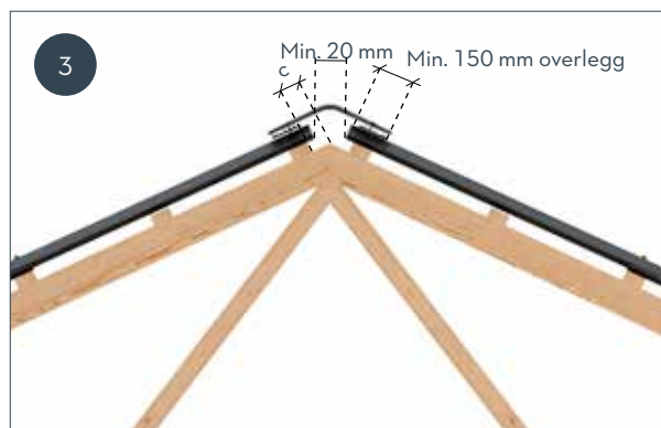
Cembrit Vinkelmøne og Cembrit møneelement til takromsventilasjon
