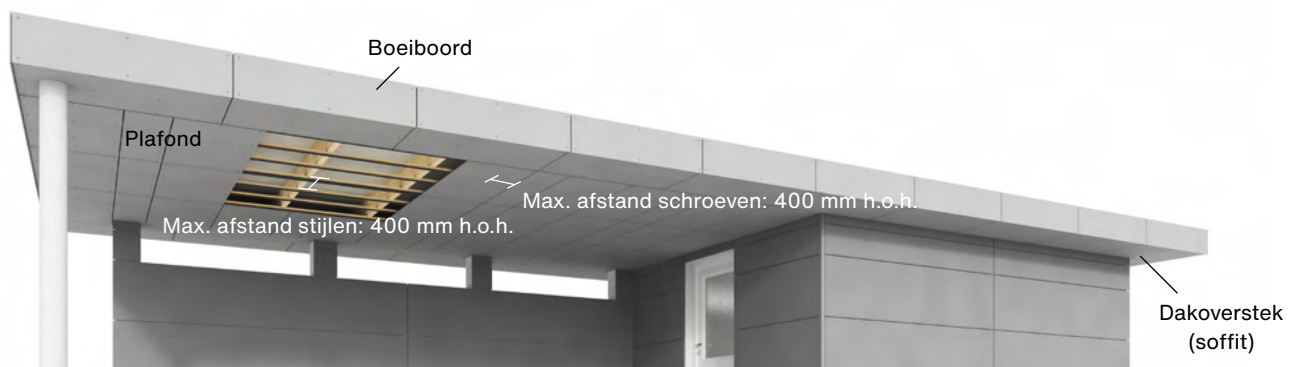
Tussenafstanden van schroeven en regelwerk
