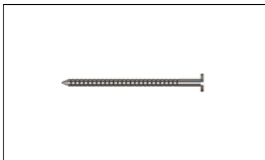
Ringnagels Verkrijgbaar op band in 2,9 x 40 mm en 2,9 x 50 mm in blank RVS en op kleur. Toepassing: nagelen Swisspearl Plank.
