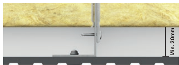
Kuva 2. Swisspearl Patina Inline -levyn asennus L -profiiliin.
