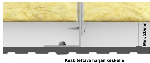
Kuva 2. Swisspearl Patina Inline -levyn asennus L-profiiliin.
