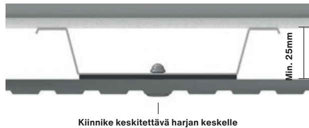
Kuva 2. Swisspearl Patina Inline -levyn asennus profiiliin keskelle
