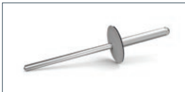
Swisspearl niitti teräsrankaan 4.8x20mm Ruostumatonta terästä. Maalaamaton tai maalattu. Puristusalue 10-14mm.
