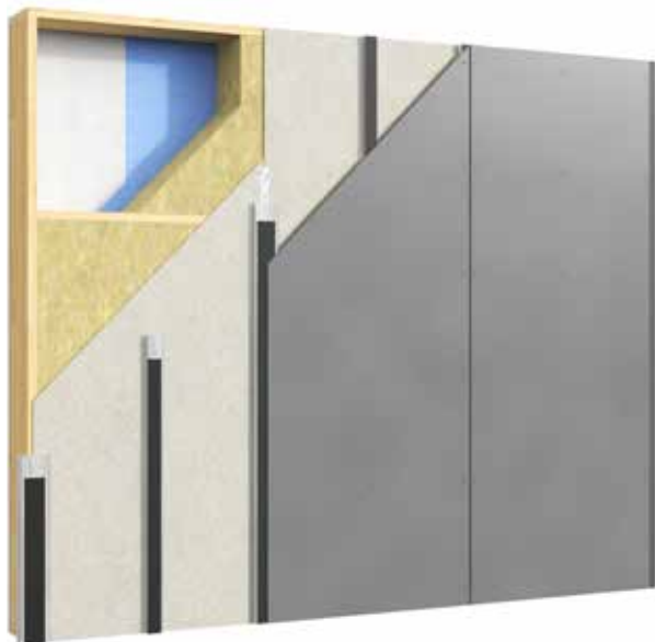
Lett vegg med vertikale stål VFL profiler
