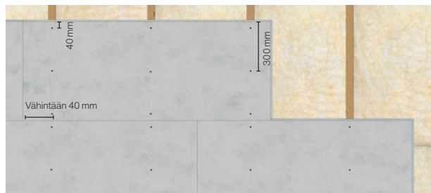
Ruuvien reunaetäisyydet ja jako ulkoseinän umpiosuoksilla.
