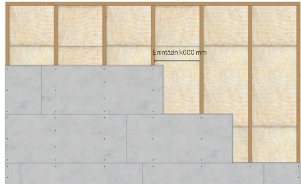
Esimerkki levyjen juoksevasta limityksestä.
