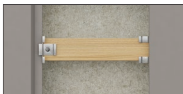
Bild 2 Swisspearl Connect clip
