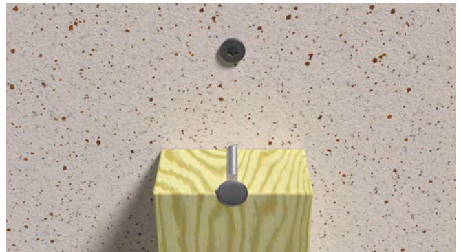
Kai tašeliai yra plokštės viduryje, būtina užtikrinti, kad viny nebūtų kalamos per arti pagrindinės konstrukcijos tašo ar profilio krašto
