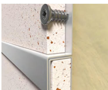
h12 profilis tvirtinamas tik per Swisspearl Windstopper plokštę aukščiau sujungimo vietos
