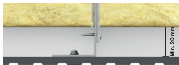
Pilt 2. Swisspearl Patina Inline plaadi paigaldamine L-profiilile
