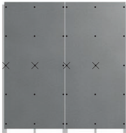
Näide: plaatide vertikaalne paigaldus, üks alumiiniumist keskmine alusroov.
