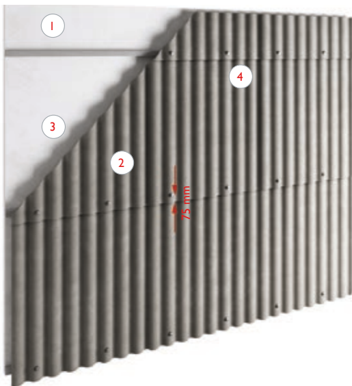
Joonis 54. Plaatide vertikaalne paigaldamine fassaadidele või seintele, pikisuunalise ülekattega ühe laine ulatuses ja ristisuunalise ülekattega 150 mm.
