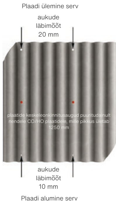
Joonis 22. Plaat CO/HO: viltu lõigatud nurgad ja kinnitusaugud. Swisspearli CO/HO plaadidel on kinnitusaugud puuritud 2. ja 5. laine harjale.
