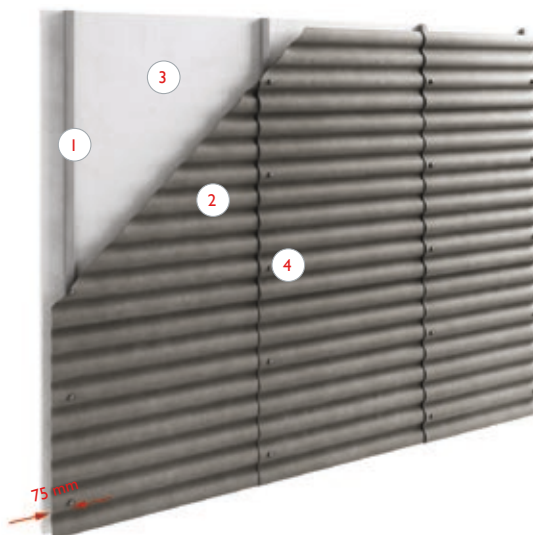
Joonis 52. Plaatide horisontaalne paigaldamine fassaadidele või seintele, pikisuunalise ülekattega ühe laine ulatuses ja ristisuunalise ülekattega 150 mm:
