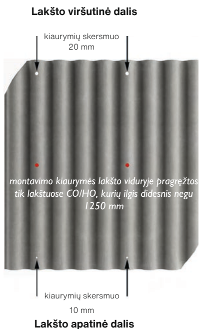
22 pav. Lakštas „Swisspearl W130-9 CO/HO“ – nupjauti kampai ir montavimo kiaurymės.
