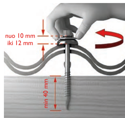
25 pav. Tradicinė „Swisspearl“ tvirtinimo sistema įsriegta nepriekaištingai. Galvutė, pagaminta iš sintetinės elastinės medžiagos negali būti deformuota nuo per didelės įsriegimo jėgos.
