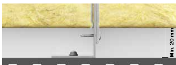
Pilt 2. Swisspearl Patina Inline plaadi paigaldamine L-profiilile
