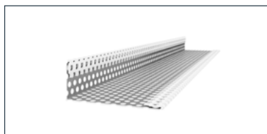
2. Swisspearli tuulutusprofiil 0,6 mm perforeeritud teras, valge. Pikkus 3000 mm.
