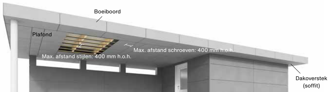
Tussenafstanden van schroeven en regelwerk
