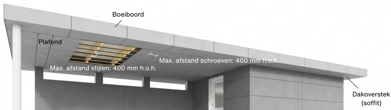
Tussenafstanden van schroeven en regelwerk
