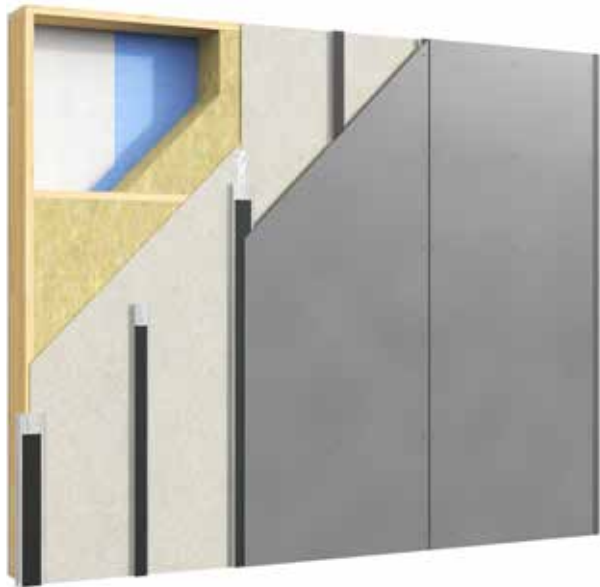
Viegļu konstrukciju siena ar vertikālu tērauda profilu pielietojumu
