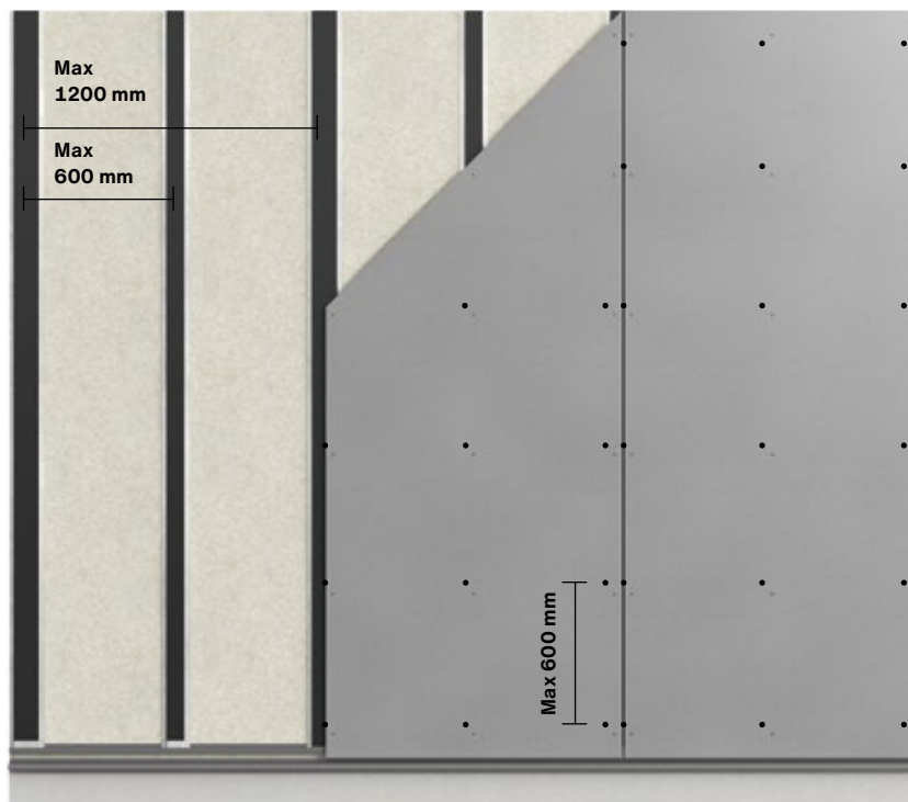
Panneaux de façade Swisspearl installés sur des profilés verticaux
