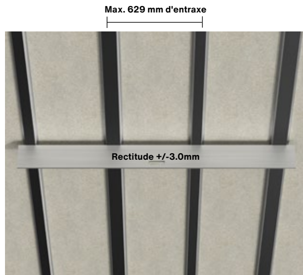
Rectitude de la sous-structure
