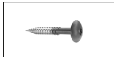
Swisspearl-julkisivuruuvi, puurankaan 4,5 x 41 mm Ruostumaton teräs A2
