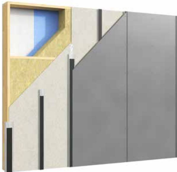
Karkasinė siena su vertikaliai išdėstytais plieniniais profiliais
