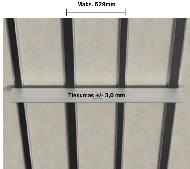
Pagrindo konstrukcijos tiesumas
