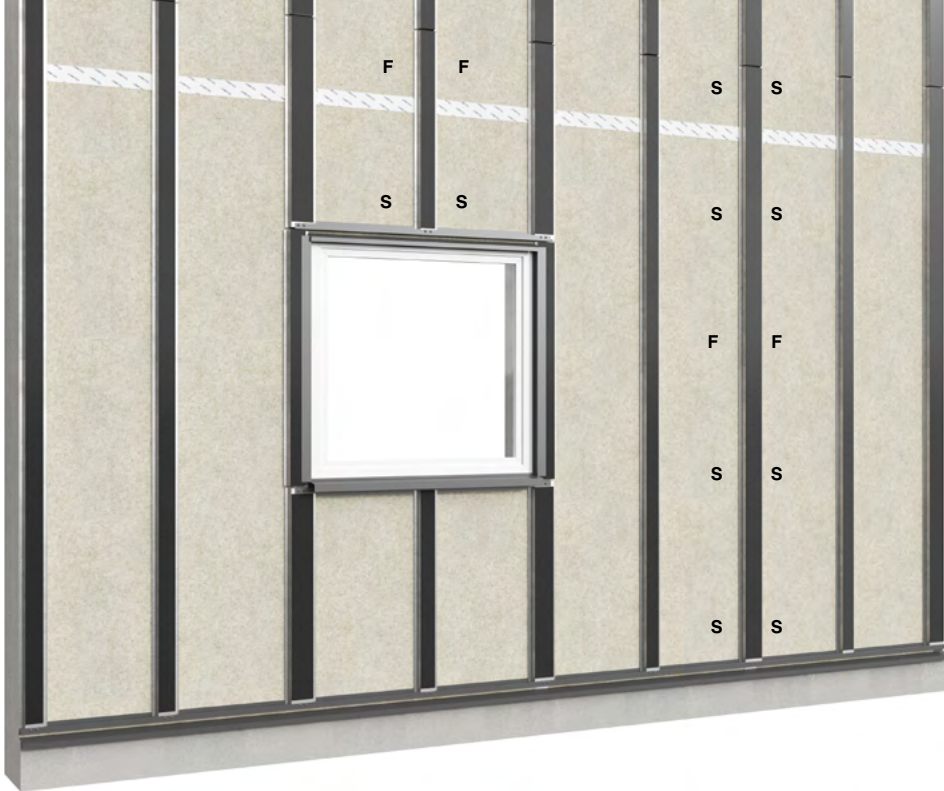
Fiksuotas tvirtinimo taškas (F) Paslankūs tvirtinimo taškai (S)
