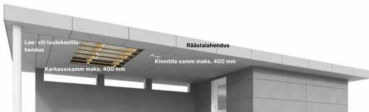
Kinnitite ja aluskarkasside vahekaugused
