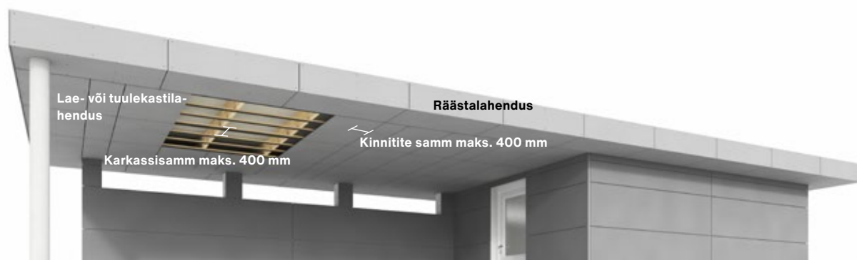
Kinnitite ja aluskarkasside vahekaugused
