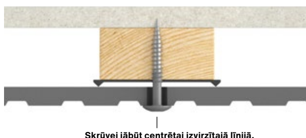
2. attēls: Swisspearl Patina Inline - stiprināšana uz starpposma balsta
