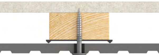
1. attēls: Swisspearl Patina Inline - stiprināšana divu plākšņu savienojuma vietā.
