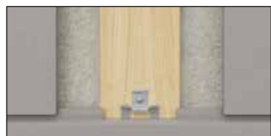
2. attēls Swisspearl Plank Connect klipši
