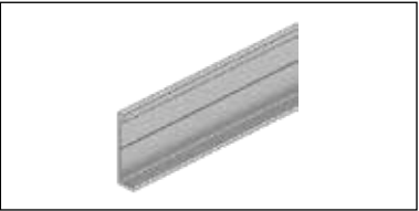
„Swisspearl Plank Connect“ vertikalaus montavimo pradžio profilis Ekstruduotas aliuminis Storis 1,1 mm Ilgis 3000 mm
