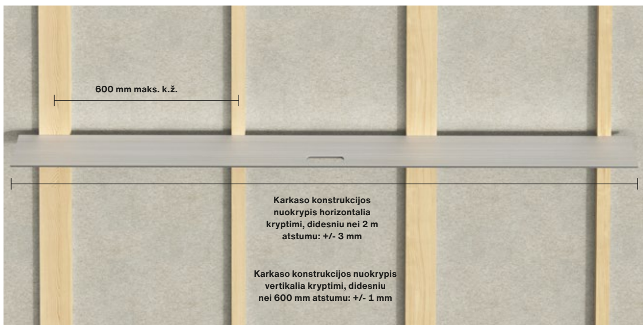
Karkaso konstrukcijos nuokrypiai
