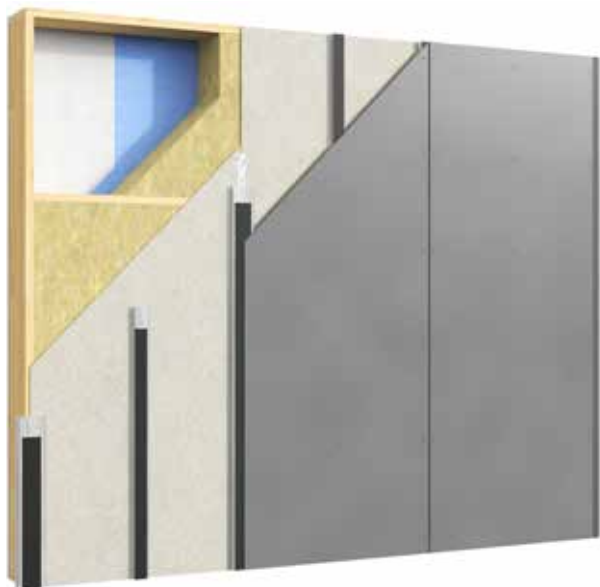
Lehká stěna se svislými ocelovými profily VFL
