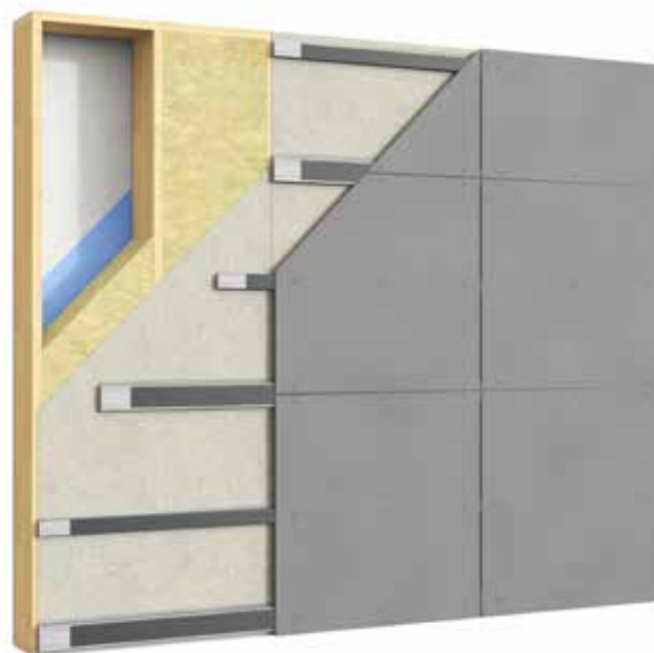
Lehká stěna s vodorovnými ocelovými profily VFL
