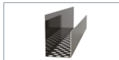
12. Větrací nástěnný profil 40 Swisspearl 25 × 40 mm, vodorovný ventilační počáteční/koncový profil, tloušťka 1 mm
