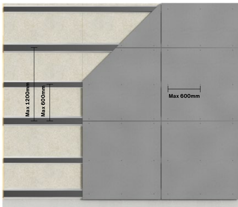
Fasádní desky Swisspearl instalované na vodorovných profilech VFL
