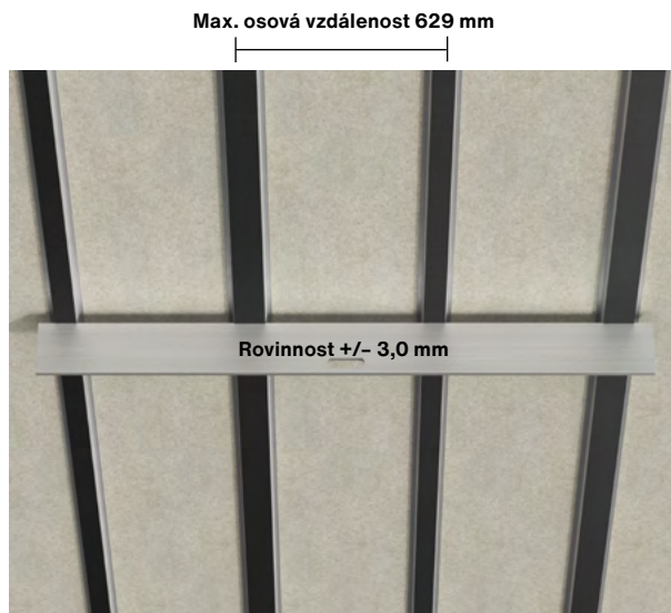
Rovinnost podkladní konstrukce
