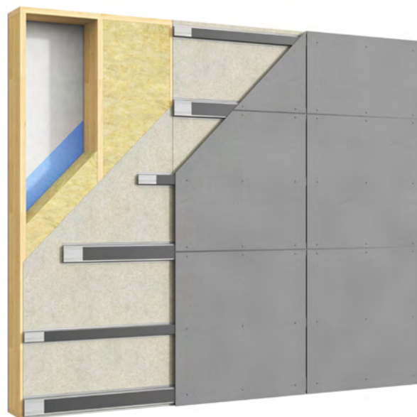
Lehká stěna s vodorovnými ocelovými profily VFL
