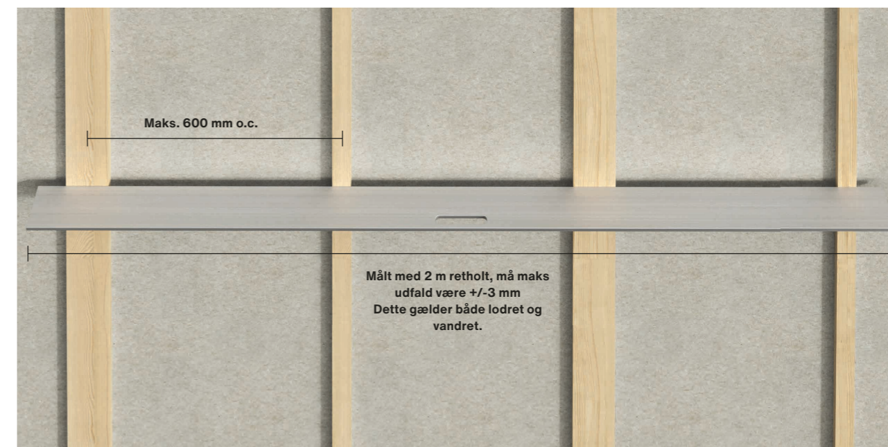
Tolerancer i underkonstruktionen
