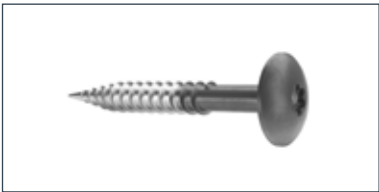
Fasádní vrut do dřeva Swisspearl Bez podložky SCR-W 4.8x40 mm A4 nerezová ocel (designová řada Swisspearl Patina)
