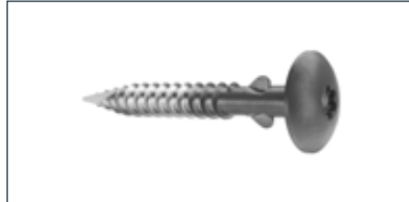
Fasádní vrut do dřeva Swisspearl s křídélky SCR-WW 4.9x38 mm A2 nerezová ocel (designová řada Swisspearl Patina) wisspearl Patina design line)
