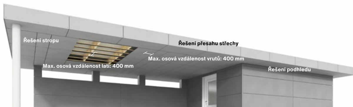
Osové vzdálenosti vrutů a latí
