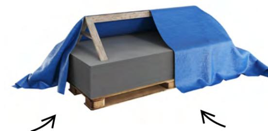
Remplacez le plastique par une bâche. Il est très important qu'il y ait une ventilation sur tous les côtés de la bâche, ainsi que sur le dessus de la palette, sous la bâche. Cela permet de réduire la condensation au maximum.
