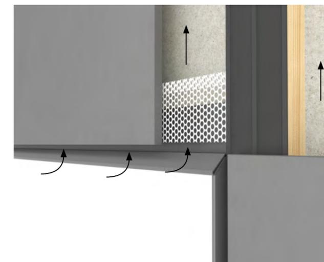
Une ouverture de ventilation horizontale libre doit également être maintenue au-dessus des fenêtres et des portes. Cet espace de ventilation doit avoir une largeur d'au moins 15 mm. Si des profilés perforés en acier, aluminium ou plastique sont utilisés, une ouverture de ventilation d'au moins 150 cm<sup>2</sup> par mètre est nécessaire. L'ouverture située à la base est également utilisée pour évacuer l'humidité qui a pénétré dans la façade.
