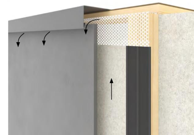
Le passage de l'air doit être maintenu en haut de la façade, qu'elle soit en contact avec un toit ou une autre structure. Tout comme à la base, un espace de ventilation d'au moins 15 mm ou 150 cm<sup>2</sup> par mètre doit être prévu.
