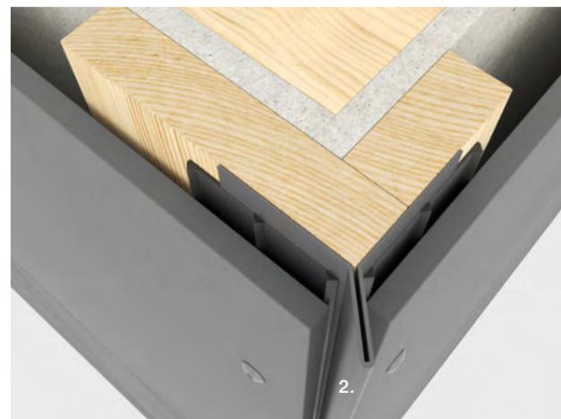
Le profilé d'angle extérieur en Y Swisspearl peut également être utilisé pour la réalisation d'angles extérieurs à 90°. Il est installé de la même manière que le profilé d'angle extérieur Swisspearl, à l'aide de clous. La distance entre le bord intérieur des panneaux de façade et le profilé doit être d'au moins 2 mm.
