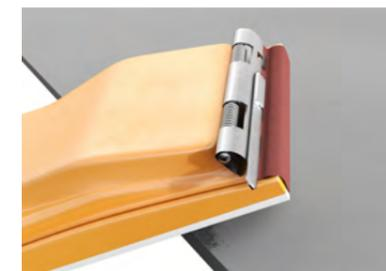
Une fois les panneaux découpés, vous pouvez chanfreiner le bord découpé à l'aide d'une ponçeuse (grain 80) pour lui donner une finition nette. Le chanfrein doit être incliné à 45° par rapport au panneau. Cela permet de conserver la résistance des bords et d'éliminer les petites irrégularités.
