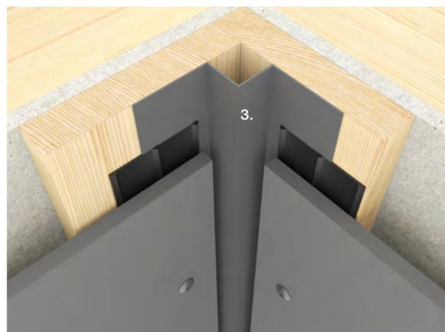
Le profilé d'angle intérieur Swisspearl est utilisé pour les angles intérieurs à 90°. Le profil est fixé à l'aide de clous à tête plate espacés de 400 à 500 mm, insérés à travers des trous pré-perçés de Ø4 mm. Il doit y avoir un espace d'au moins 4 mm entre le bord du panneau et le profilé.
