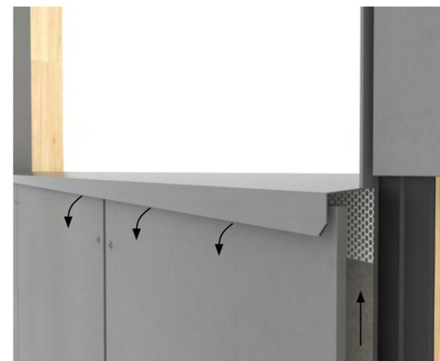
Une ouverture de ventilation horizontale d'au moins 15 mm ou équivalente à 150 cm<sup>2</sup> par mètre doit être maintenue sous les fenêtres ou autres ouvertures où un seuil est utilisé. Cet espace de ventilation se situe généralement entre le bord supérieur des panneaux de façade et le bord inférieur du seuil. Il est recommandé que le seuil dépasse d'au moins 30 mm par rapport à l'avant de la façade. Cela garantit que l'eau s'écoulant du seuil ne pénètre pas dans la structure.
