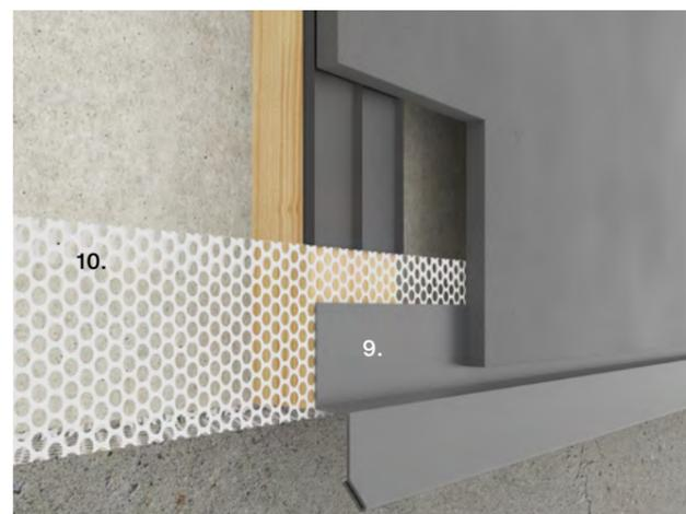
Le profilé d'égouttage Swisspearl est utilisé pour évacuer l'eau de la structure ou lorsque des finitions soignées sont nécessaires en pied de façade. Le profilé peut être utilisé en combinaison avec le profilé de ventilation Swisspearl pour s'assurer que les insectes, parasites ou autres, ne peuvent pas pénétrer dans la cavité derrière les panneaux de façade. Il doit y avoir un espace d'au moins 4 mm entre le bord du panneau et le profilé.
