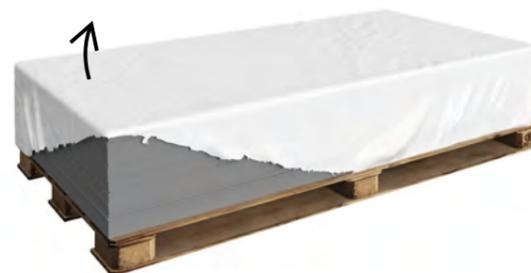
Si les palettes sont stockées à l'extérieur lorsqu'elles arrivent sur le chantier de construction, le film en plastique doit être retiré. Les panneaux de façade doivent être stockés sur la palette ou les traverses, avec un espacement maximal de 500 mm entre chaque panneau.
