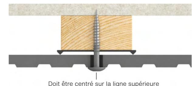
Fig. 2. Pose des panneaux Swisspearl Patina Inline NXT sur latte intermédiaire.
