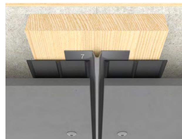
Le profilé de joint Swisspearl peut être utilisé comme profilé de joint vertical et horizontal. Il n'est pas obligatoire d'utiliser le profilé de joint Swisspearl, mais il offre une excellente finition. Le profilé se pose de la même manière que le profilé d'angle extérieur Swisspearl. Il doit y avoir un espace d'au moins 4 mm entre le bord du panneau et le profilé de joint Swisspearl.
