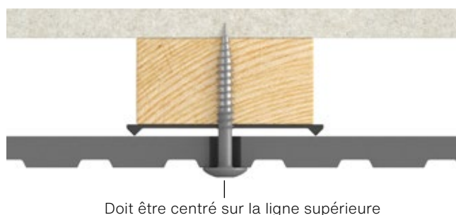
Fig. 2. Pose des panneaux Swisspearl Patina Inline NXT sur latte intermédiaire.
