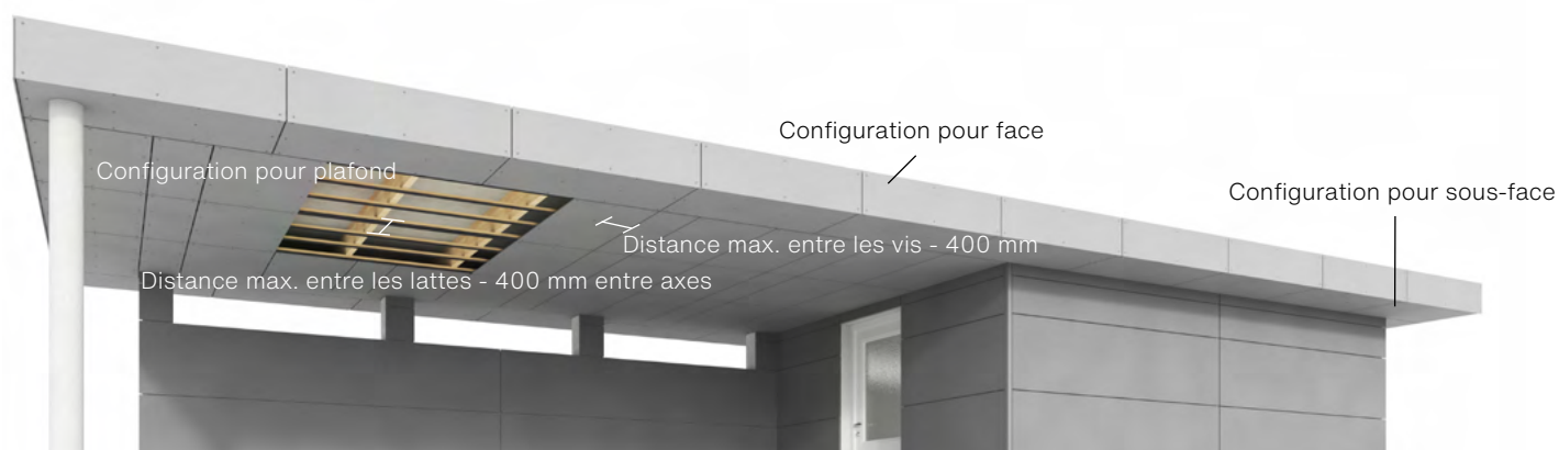
Distances entre les vis et distance entre les lattes
