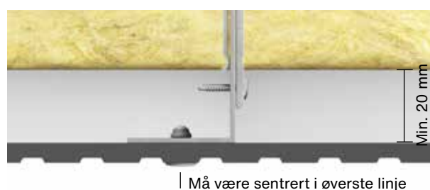
Fig. 2. Montering av Swisspearl Patina Inline NXT på L-profil.
