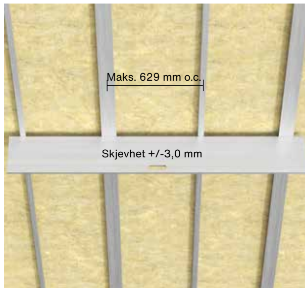
Retthet i underkonstruksjon
