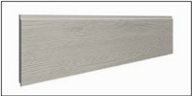
Swisspearl Plank Connect – Gestructueerd oppervlak Eigenschappen Lengte 3000 mm Totale breedte 210 mm Werkende breedte 200 mm Dikte 11,2 mm Gewicht 10,13 kg Oppervlak Gestructueerd Dekking 1,67/m² Bevestigingen 110/m²
