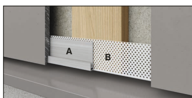
Foto 7 A. Swisspearl Plank Connect Startprofiel B. Swisspearl Ventilatieprofiel
