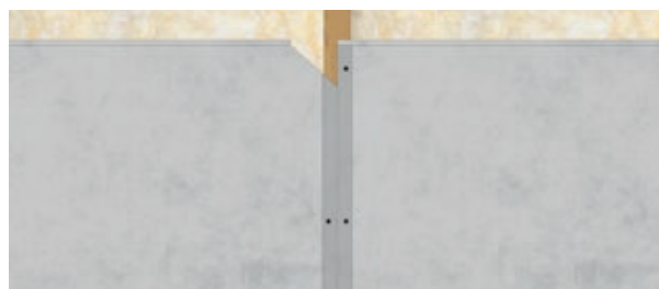
Voegen van afgezaagde panelen moeten worden afgeplakt
