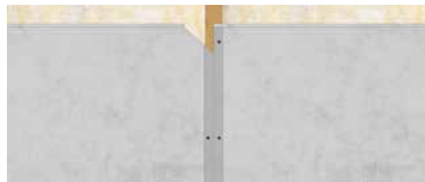
Tildannede plader tapes over samlinger
