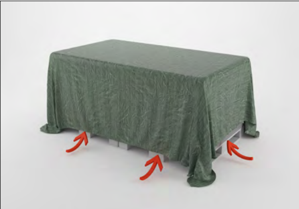
Decken Sie den Stapel mit einer Plane ab und sorgen Sie für ausreichende Unterlüftung der Plane.
