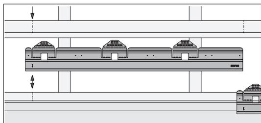
Les profilés de départ sont alignés au traçage vertical et fixés avec au moins 3 clous 2,5×35 mm.
