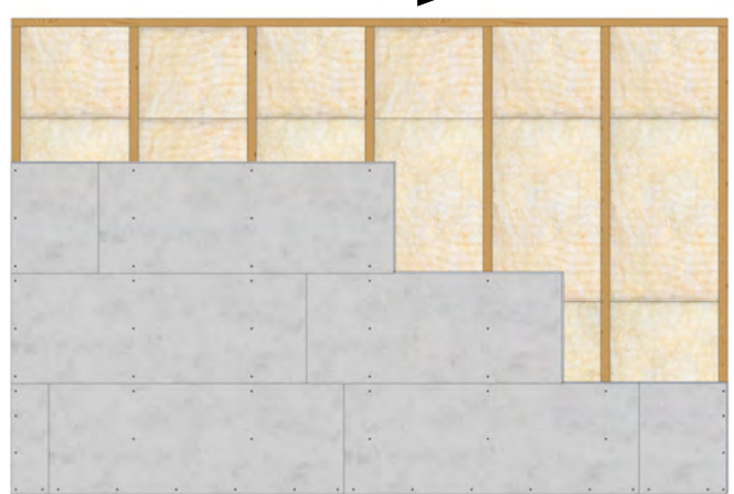
Voorbeeld van Swisspearl Windstopper Connect met verspringende voegen
