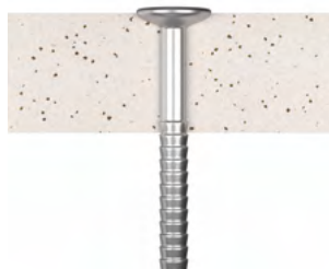
nagel plaatsen: Swisspearl Windstopper 4,5 mm en 9,0 mm
