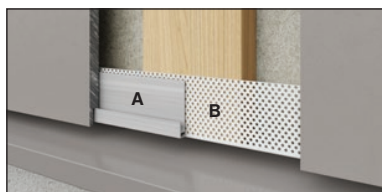
Illustrasjon 7: A. Swisspearl Plank Connect startprofil B. Swisspearl ventilert profil
