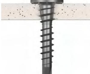
schroef plaatsen: Swisspearl Windstopper 4,5 mm
