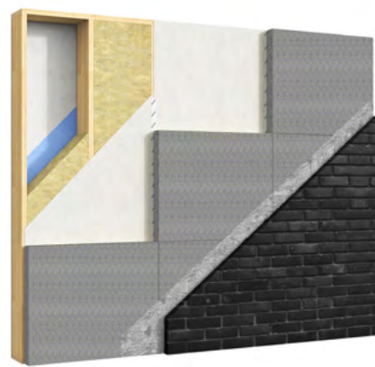
Typische opbouw voor een constructie met Swisspearl Windstopper
